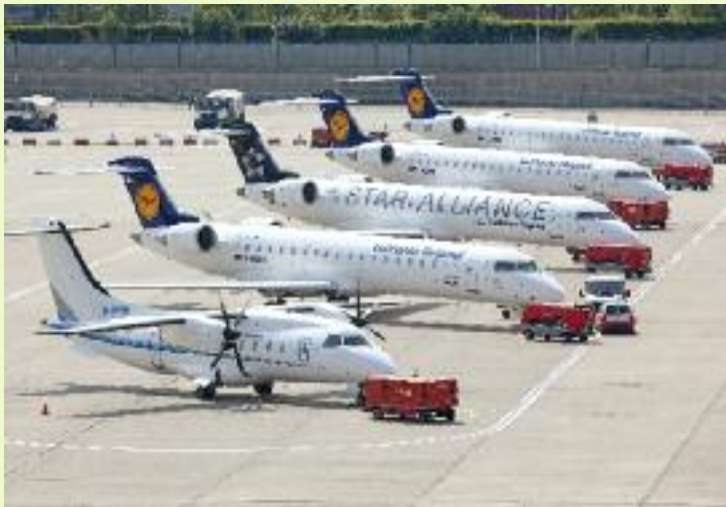
Dieselmotoren (Ground Power Units) versorgen die Flugzeuge an den Außenpositionen mit Strom
