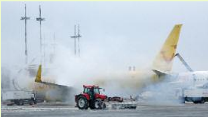
Bei der Enteisierung von Flugzeugen wird weitmöglichst heißes Wasser eingesetzt, um den Verbrauch an Enteisierungsmitteln zu minimieren
