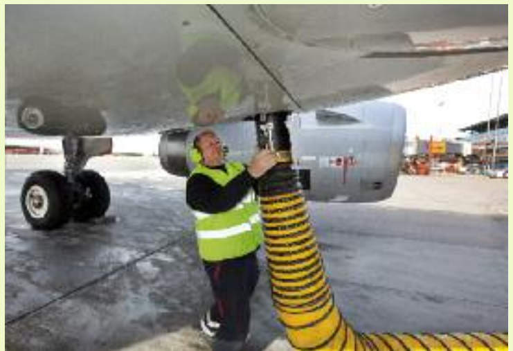
An den Pierpositionen werden die Flugzeuge über das BHKW mit Strom und klimatisierter Luft versorgt
